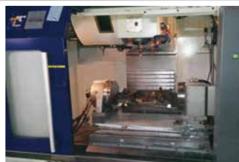
本中間板為 汽車三角架加工 油壓治具
